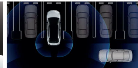
ระบบช่วยเตือนขณะถอยรถ RCTA (Rear Cross Traffic Alert)
